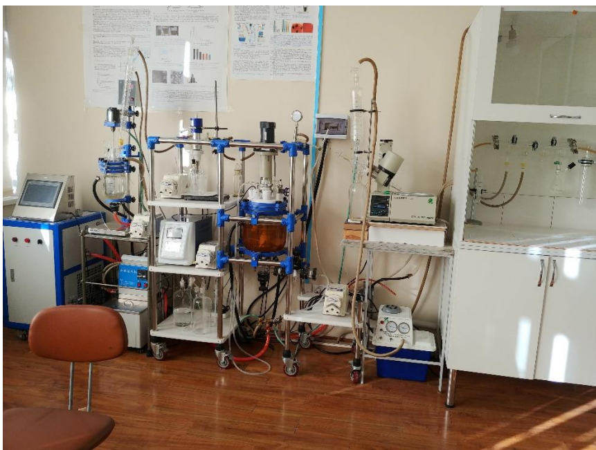
სურათი 4. შლენკის ხაზის მიერთება უტბ-თან. მოდერნიზებული უტბ. მოდერნიზებული უტბ ასევე დატვირთულია ტუმბოიანი შპრიცით (სურ. 5).
