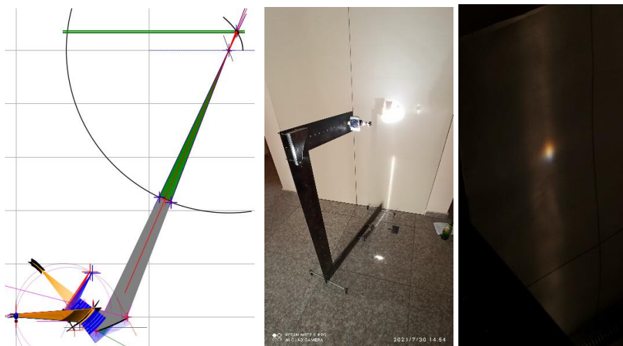
ნახ. 4. მარცხენა სურათი - Python - ზე დაპროგრამებული სპექტრომეტრი; შუა - დაპროგრამებული ვერსიის მაქსიმალურად ზუსტი რეალიზაცია; მარჯვენა სურათი - გვაჩვენებს მიღებულ სპექტრს ხილულ დიაპაზონში.
