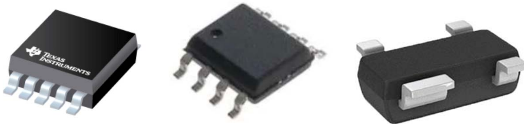
სურ. 45. Texas Instruments ADS1113 16 ბიტანი ADC (მარცხნივ), MICROCHIP ის ATTINY85 მიკროკონტროლერი (ცენტრი) და Maxim Integrations ის MAX6816 ერთ არხიანი დებოუნსერი.
