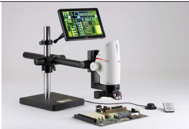
სურ. 32. Leica DMS300 კვლევებისთვის გამოყენებული ციფრული მიკროსკოპი
