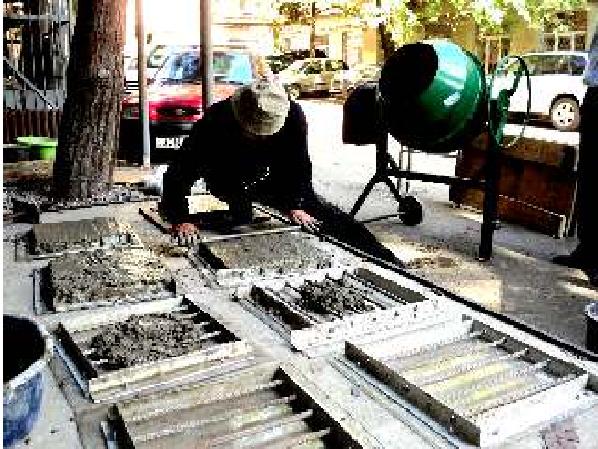
სურ.8. სამუშაო პროცესი ალმასების და კომპოზიციური მასალების სამეცნიერო ცენტრში შექმნილი ბეტონ-ამრევის გამოყენებით
