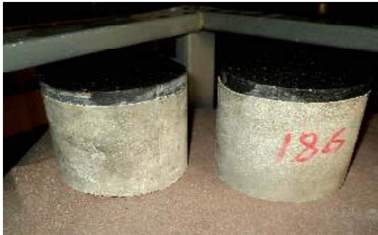
სურ.6. ცილინდრული ფორმის ორშრიანი ბეტონის ნიმუშები
