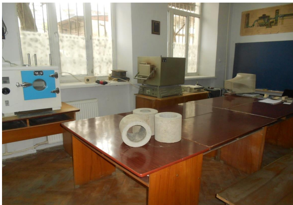
სურ.3. ბეტონის მილის მოდელები
