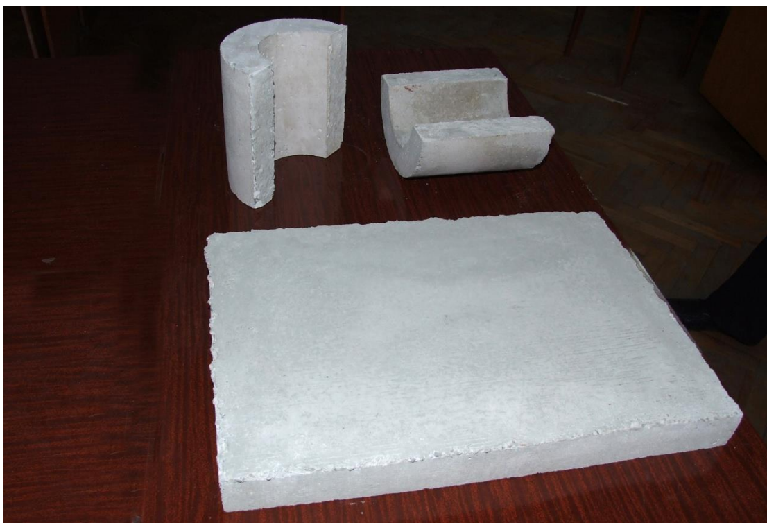
სურ. 1. სწრაფმაგრებადი ცემენტის ბაზაზე მიღებული ბეტონით დამზადებული ღარის და ფილის მოდელები
