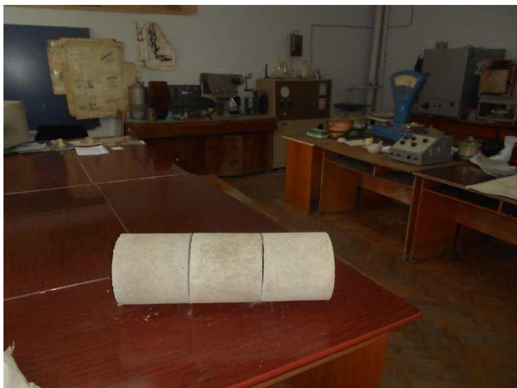
სურ.4. აწყობილი ბეტონის მილის მოდელი
