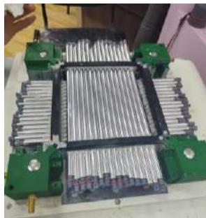
სურ. 12 ახალი 3D ტექნოლოგიები გამოყენება დეტექტორის აწყობის პროცესში
