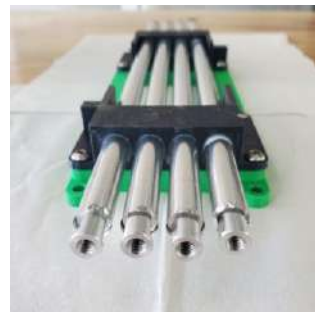
სურ. 12 ახალი 3D ტექნოლოგიები გამოყენება დეტექტორის აწყობის პროცესში
