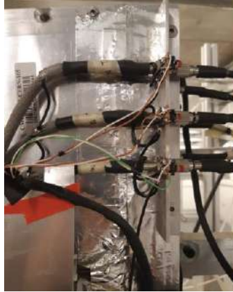
სურ. 9 მოდიფიცირებული მაღალი ძაბვის წრედები მცირე დენების გასაზომად.
