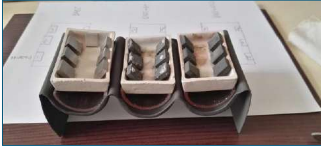
სურ.3. ერთ-ერთი ციკლის დაჟანგული ნიმუშები (მარცხნივ). შედარებითი კინეტიკური მრუდების გაერთიანებული დამოკიდებულება ალუმინით, ქრომალუმინით დაფარული და დაუფარავი DADI-ისათვის და ასევე რეფერენს P92 შენადნობისათვის (მარჯვენა გრაფიკული გამოსახულება)
