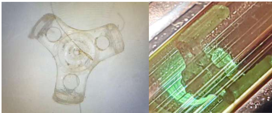
სურ. 14 4 მ სტროუსთვის განკუთვნილი სპეისერი და სტროუს შიგნით სპეციალურ ლოკაციაზე მოთავსებული სპეისერის სურათი
