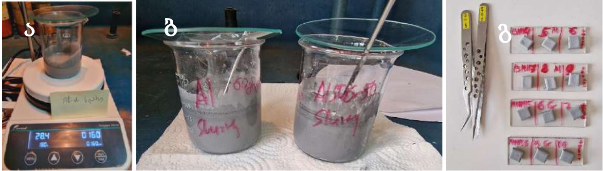
სურ.1. (ა) ალუმინის სლარის შეზავების პროცესი ცხელი ზედაპირის მქონე მაგნიტურ სარეველაზე, (ბ) შეზავებული და დეპონირებისათვის გამზადებული ალუმინის მიკრონაწილაკებისა და ალუმინ-ქრომის მიკრონაწილაკების სლარები, (გ) საილუსტრაციოდ მოყვანილი რამოდენიმე DADI -ის სუბსტრატზე დატანილი ორივე კომპოზიციის სლარი, მზად მაღალტემპერატურული გამოწვისთვის არგონის ატმოსფეროში
