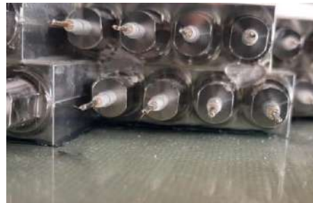
სურ. 11 ტრეკული დეტექტორის 3-4 მოდულისთვის მომზადებულ კომპონენტები და მისი აწყობის პროცესი
