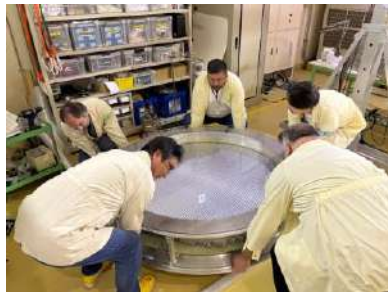
სურ. 11 ტრეკული დეტექტორის 3-4 მოდულისთვის მომზადებულ კომპონენტები და მისი აწყობის პროცესი
