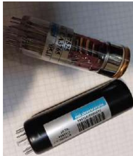
სურ. 1 ნოლ გრადუსზე კალორიმეტრის ძველი (გამჭვირვალე კორპუსით) და ახალი (შავ გარსაცავში) ფოტოგამამრავლებლები
