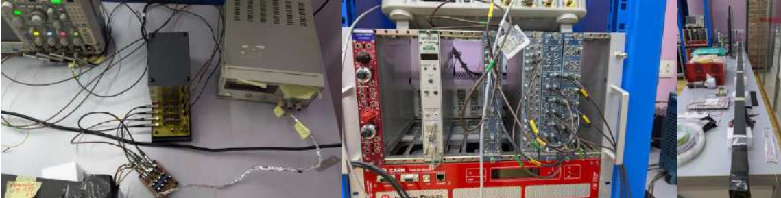
სურ. 32 სტენდი 4 CRV სტრიპისგან, ჩართული თანხვედრაში კოსმოსურ ტელესკოპთან და მათი სიგნალების ვიზუალიზაცია Kesight InfiniiVision MSOX3104T ოსცილოგრაფის მეშვეობით
