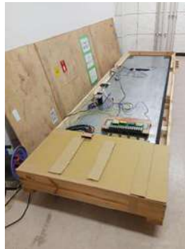
სურ. 24 საცდელი 3.2 მ სიგრძის CRV მოდული J-Parc-ში. SiPM მიერთებული ფრონტ-ენდ და მონიტორირების/კალიბრების ელექტრონიკით
