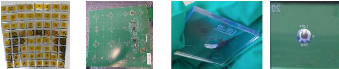
სურ. 7 SiPM Tile მოდული ზედა და ქვედა მხარეები (მარცხნივ), ერთი სცინტილატორის ფილა და SiPM
