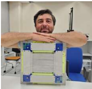
სურ. 14 დასრულებული 5მმ სტროუებისგან შემდგარი პროტოტიპი
