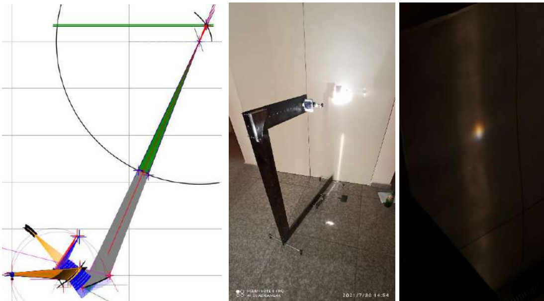
ნახ.4 - ზე მოცემულია სამ ასფერულ ზედაპირიანი პითონში დაპროგრამებული ვერსია და მისი განხორციელება.
