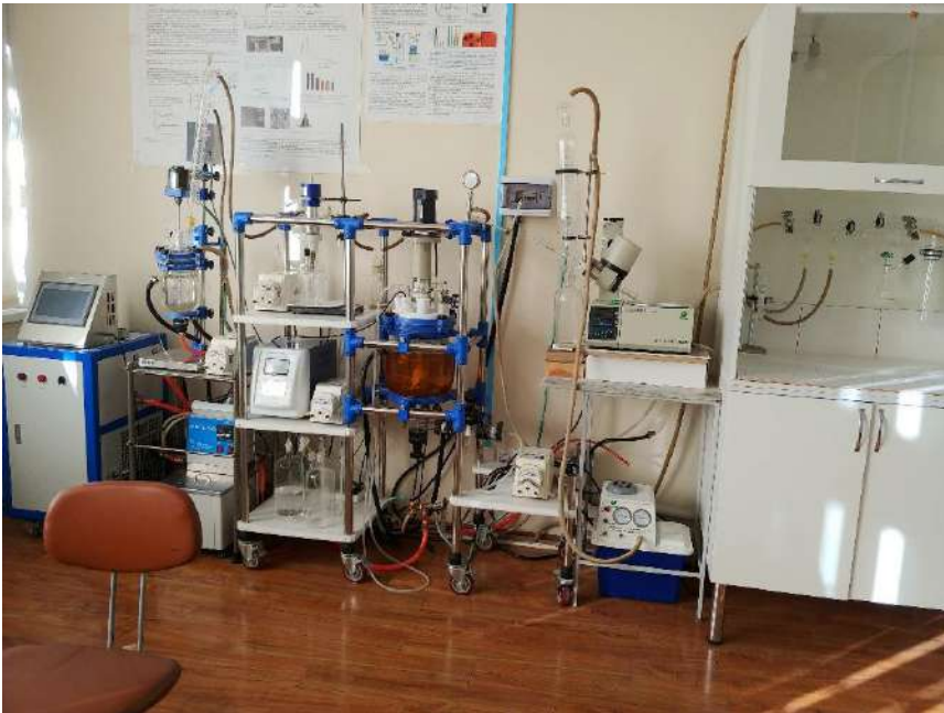
სურათი 4. შლენკის ხაზის მიერთება უტხ-თან. მოდერნიზებული უტხ.
