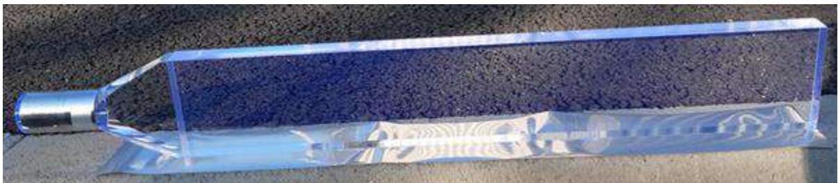
სურ. 7 ტრიგერში გამოყენებული სქელი სცინტილატორები
