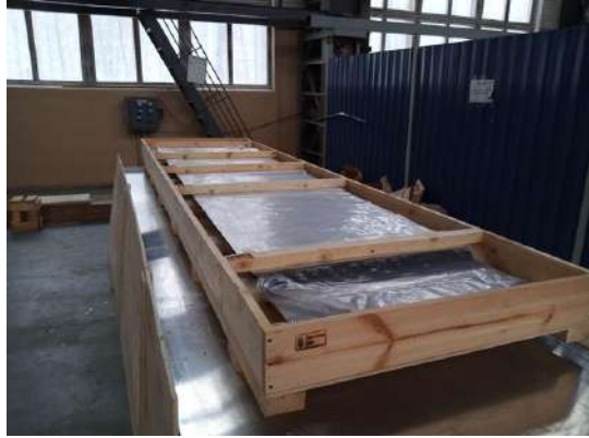
სურ. 24 CRV მოდული, გამზადებული გადასავ ზავნად: მისი ზომებია 3.5 მეტრი სიგრძის და 830 მმ სიგანის, 57 მმ სიმაღლის და მიახლოებით 290 კგ წონის
