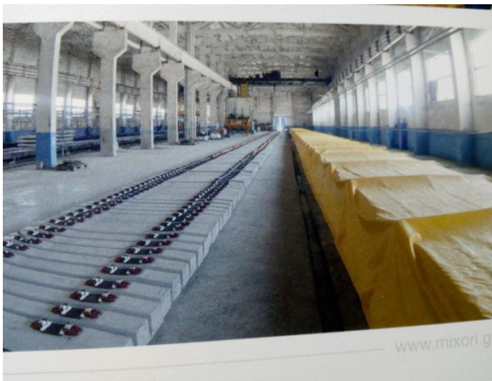
სურათი 4. მიმდინარეობს თბოტენიანი დამუშავების რეჟიმი
