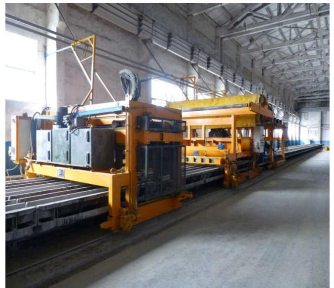
სურათი 3. დანადგარი რომელიც უზრუნველყოფს სპეციალური ტილოს გადაფარებას კასეტურ ფორმებზე
