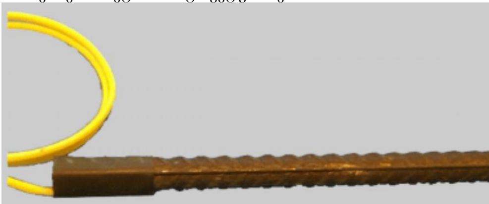
ნახ. 8. ბოჭკოვან-ოპტიკური სენსორი ძაბვის და დეფორმაციის საზომი ლითონის ზედაპირზე.
