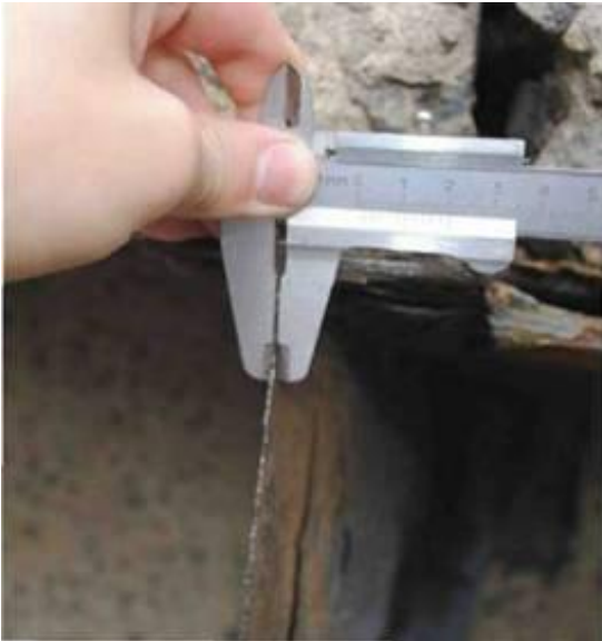
სურ. 1. ნარჩენი სისქის შტანგენციურკულით განსაზღვრა
