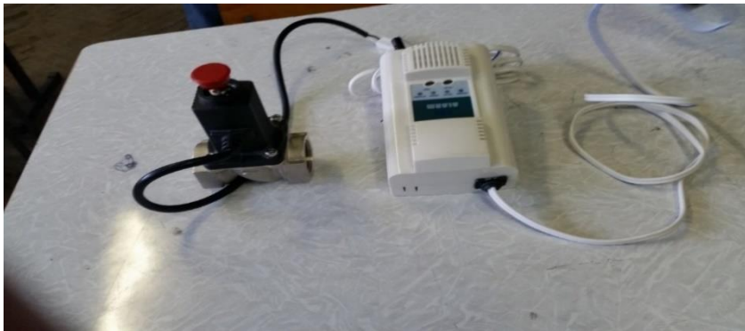
ნახ.2. ბუნებრივი აირის გაჟონვის სიგნალიზაციის ახალი ხელსაწყოს საერთო ხედი
