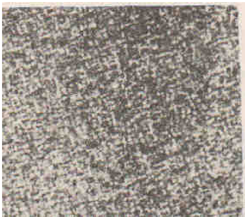
სურ. 1.1.2. უწყვეტი დაშლა შენადნობში \text{Cu}_3\text{Au}+8(\text{ატ.})\%\text{Ag} , ნაწრობი 800^\circ\text{C} –დან და დაძველებული 400^\circ\text{C} –ზე 200სთ (მატრიცა მოწესრიგებულია). X50000
