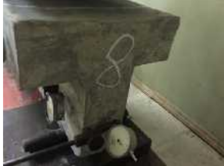
ნახ.4. რკინაბეტონის შედგენილი კვეთის კოჭი
