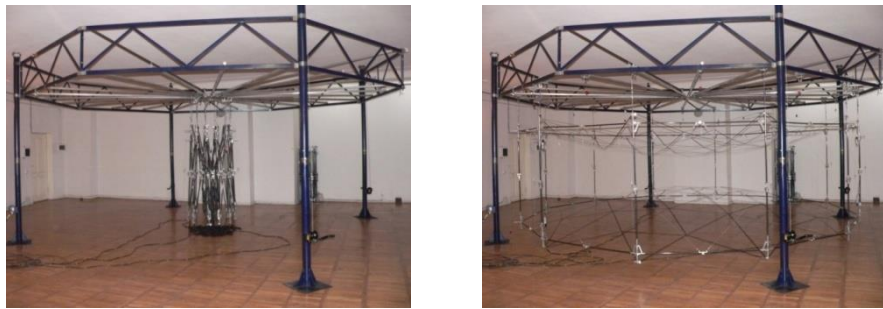
ნახ.10 -ვანტურ-ღეროვანი გასაშლელ რგოლიანი, მოქნილი დაჭიმულ ცენტრიანი გასაშლელი კოსმოსური რეფლექტორის ექსპერიმენტული ვარიანტი
