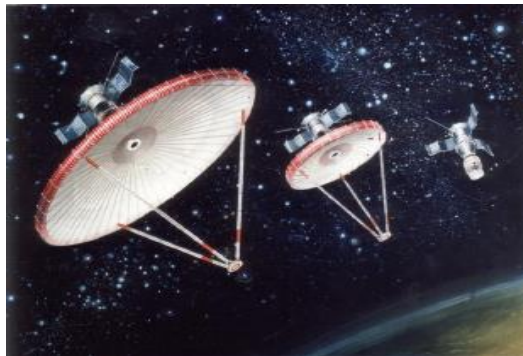
ნახ .4 - 30-მეტრიანი რეფლექტორის ბაზაზე აგებული პირველი ტიპის კოსმოსური კომპლექსი
