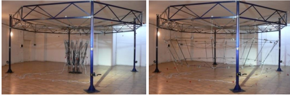
ნახ. 9 -წაკვეთილი პირამიდის ფორმის მქონე, „ჩასატეხ“ ღეროებიანი, ზამბარებით გასახსნელ რგოლიანი და მოქნილი, დაჭიმულ ცენტრიანი გასაშლელი კოსმოსური რეფლექტორის გაშლის ფოტოციკლოგრამა
