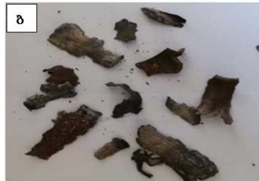
ნახ.28 აფეთქების შედეგად ფოლადის გარსაცმის ფრაგმენტაციის ტიპური სურათები: ა - V ; ბ - VI
