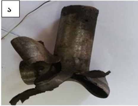
ნახ.27 აფეთქების შედეგად ფოლადის გარსაცმის დეფორმაცია/რღვევის ტიპური სურათები: ა - III ; ბ - IV
