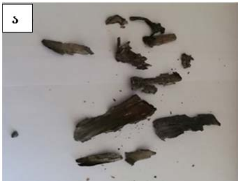
ნახ.28 აფეთქების შედეგად ფოლადის გარსაცმის ფრაგმენტაციის ტიპური სურათები: ა - V ; ბ - VI
