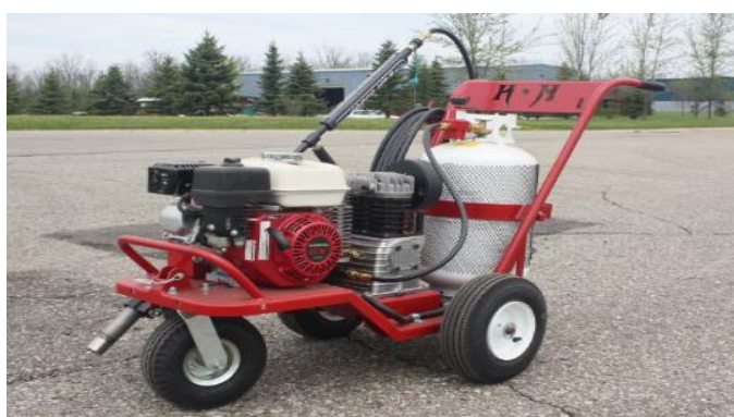
ნახ. 5 ასფალტის გამაცხელებელი Crack Jet II
