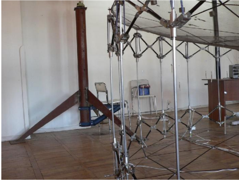
ფიგ. 1.9. _ გამშლელი რგოლის დგარები, რეფლექტორის გაშლილ მდგომარეობაში, დრეკადობის ფარგლებში იღუნება
