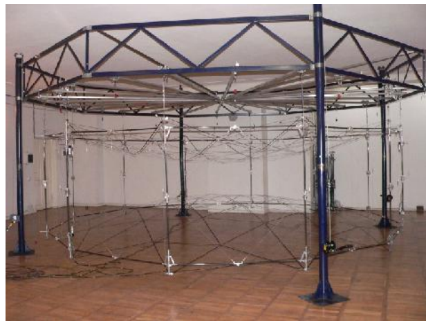
ფიგ. 1.13. - ვანტურ-ღეროვანი გასაშლელ რგოლიანი, მოქნილი დაჭიმულ ცენტრიანი გასაშლელი კოსმოსური რეფლექტორის ექსპერიმენტული ვარიანტის გაშლის 12-კადრიანი ფოტო-ციკლოგრამა.
