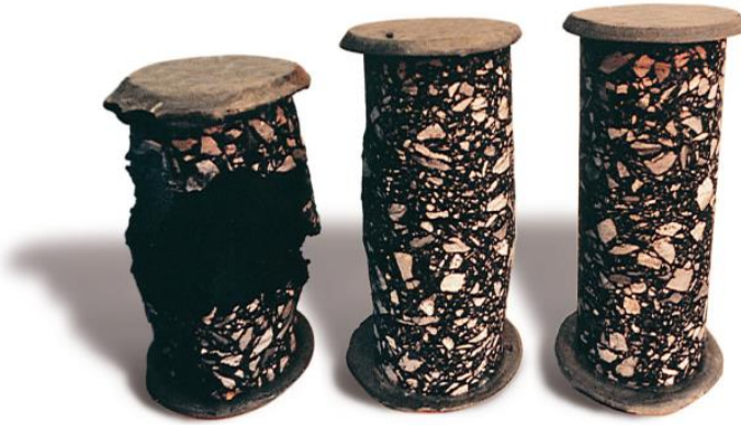
ნახ.3 არამოდიფიცირებული და ელვალის პოლიმერით მოდიფიცირებულ ბიტუმებით დამზადებული ასფალტბეტონის ნიმუშების გამოცდის შედეგები
