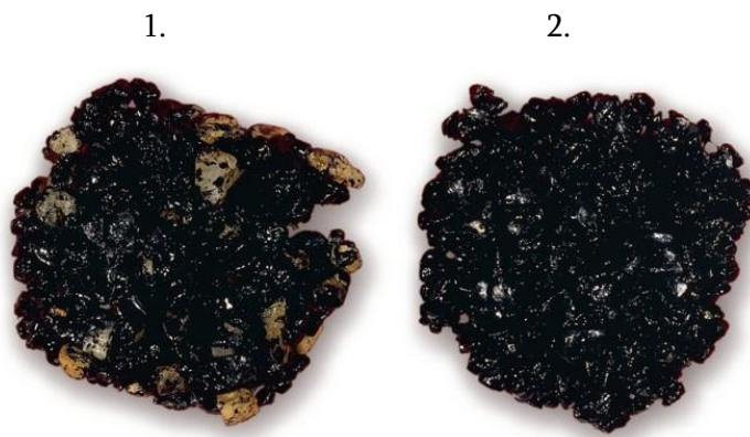
ნახ. 2. არამოდულიკირებული და ელვალის პოლიმერით მოდიფიცირებული ბიტუმებით დამზადებული ასფალტბეტონის ნარევი
