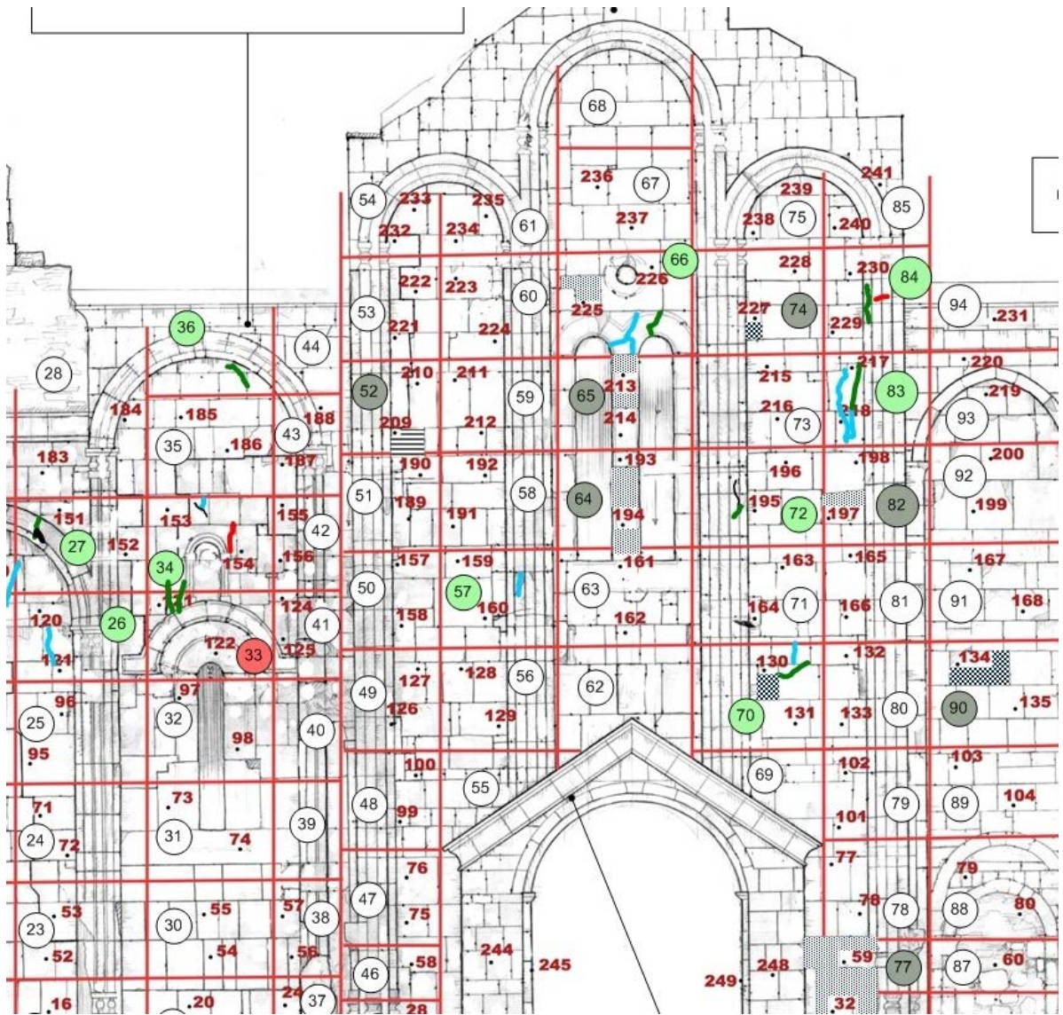
ნახ.2. ჩრდილოეთ ფასადის კედლის ტექნიკური კვლევის რუქა დაზიანებებითა და საკვლევი წერტილებით.
