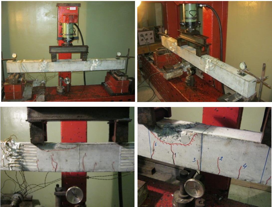
ნახ. 10 რკინაბეტონის კოჭების გამოცდა
