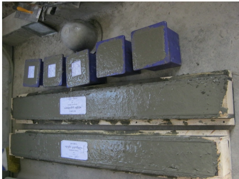
ნახ. 9 რკინაბეტონის კოჭების დაბეტონება
