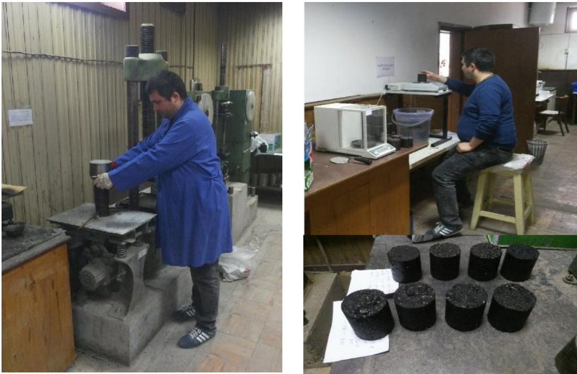
ნახ.3 ლაბორატორიაში ასფალტბეტონის ცილინდრების სხვადასხვა მარკის ბიტუმით დამზადება-გამოცდის პროცესი
