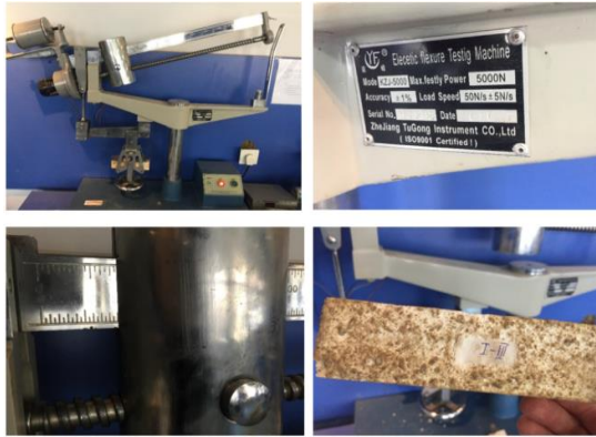
სურათი 10 ექსპერიმენტის შედეგად მიღებული ნიმუშების ლუნვაზე სიმტკიცის ზღვარის განსაზღვრა
