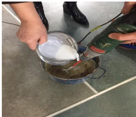
სურათი 3 პოლივინილაცეტატის (პვა) დამატების პროცესი
