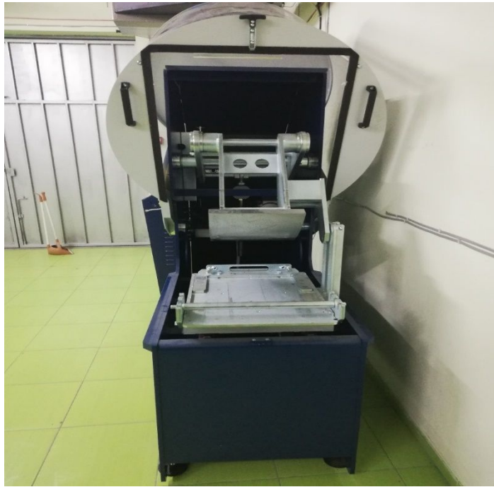
სურ. 2 Hamburg wheel track მოწყობილობა.
