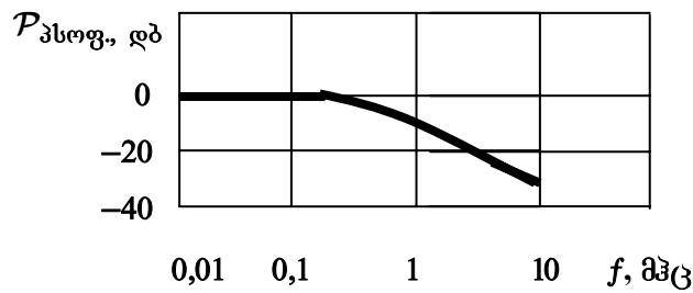
სურ. 1.17. ამწონი ფილტრის სიხშირული მახასიათებელი შავ-თეთრი ტელევიზიისათვის
