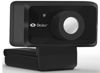
ნახ.2.19. Oculus Rift DK2 პოზიციის განმსაზღვრელი მოწყობილობა (OCULUS VR, LLC, 2015)
