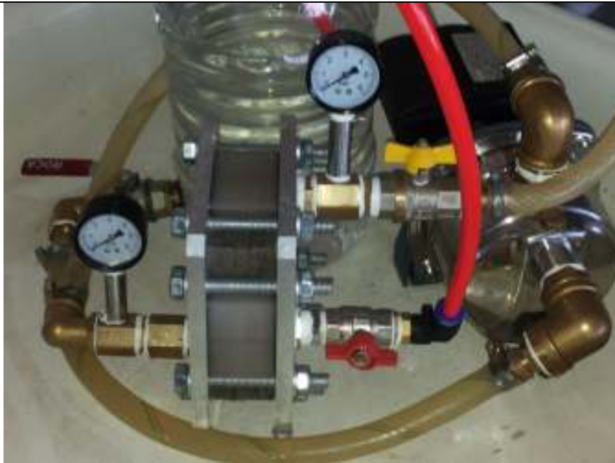
სურათი 14. პილოტური (ნახევრადსაწარმოო) ნანოფილტრაციული მემბრანული დანადგარი.
