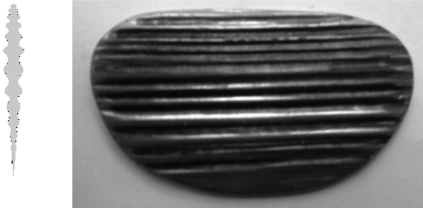
ნახ. 5. თავისუფლად ღინებადი მიკროჰესის ფრთის ტალღური კონსტრუქცია
