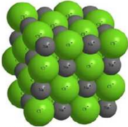
სურ. 1.11. იონური კავშირის მოდელი \text{NaCl} -ის კრისტალში
