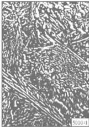
სურ. 6.14. ზედა ბეინიტური სტრუქტურა
