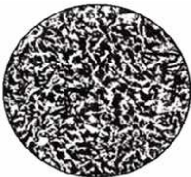
სურ. 5.28 ორფაზა შენადნობის მიკროსტრუქტურა პერიტექტიკური გარდაქმნის შემდეგ
