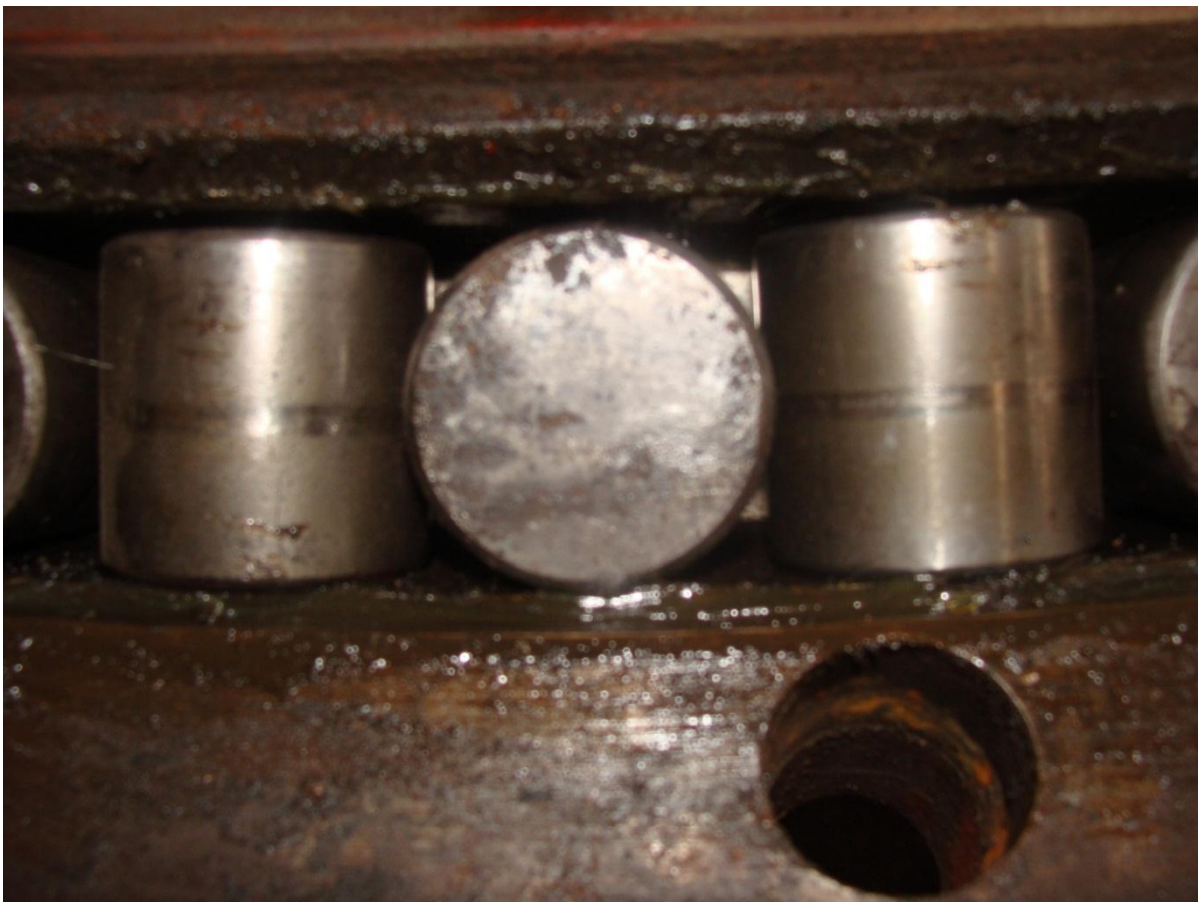
Рис. 1 Следы интенсивного износа роликов безсепараторного подшипника
