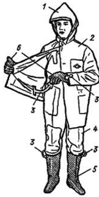
ნახ. 6.4. მაეკრანებელი კოსტუმი: 1 – დენგამტარი ქსოვილის კაპიშონი, რომელიც მიკერებულია ქურთუკზე; 2 – დენგამტარი ქსოვილის ქურთუკი; 3 – კოსტუმის ცალკეულ ელემენტებს შორის ელექტრული კავშირის განმახორციელებელი გამტარები; 4, 5, 6 – დენგამტარი ქსოვილის შარვალი, ჩექმები და ხელთათმანები
