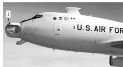
ნახ. 4.101. ბ. თვითმფრინავზე ბაზირებული რაკეტული იარაღი: 1 - მეგავატური კლასის ქიმიური ლაზერი
