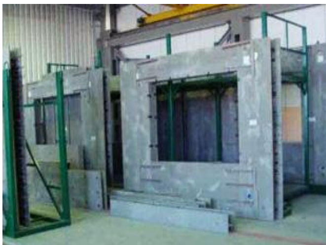
ნახ.2. ცემენტ-ბოჭკოვანი მოუხსნადი ყალიბი (ა) და ყალიბის შიდა და გარე კედლების შეერთება და არმირება (ბ)
