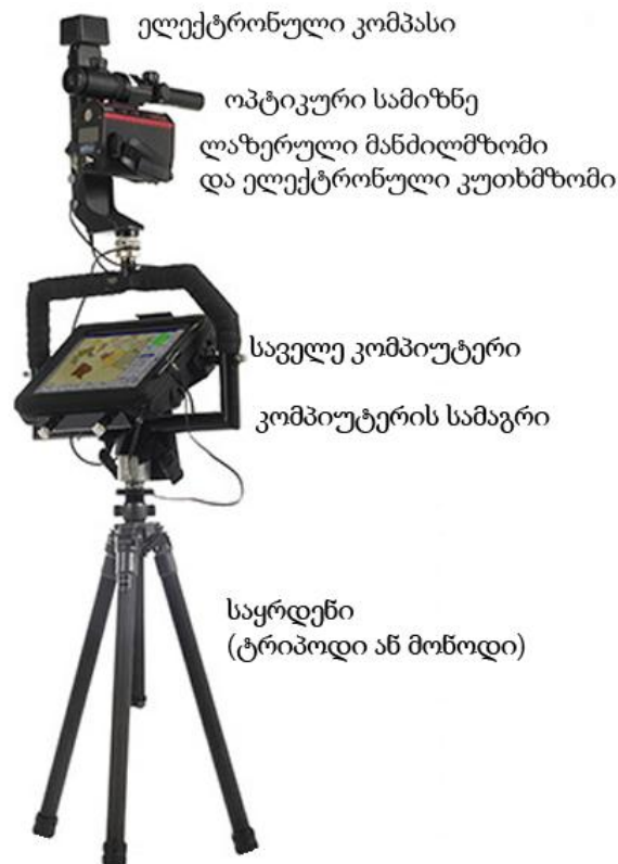
ნახ. 1. ტექნოლოგიაში გამოყენებული საველე საზომი ხელსაწყოების ერთ-ერთი კომპლექსი
