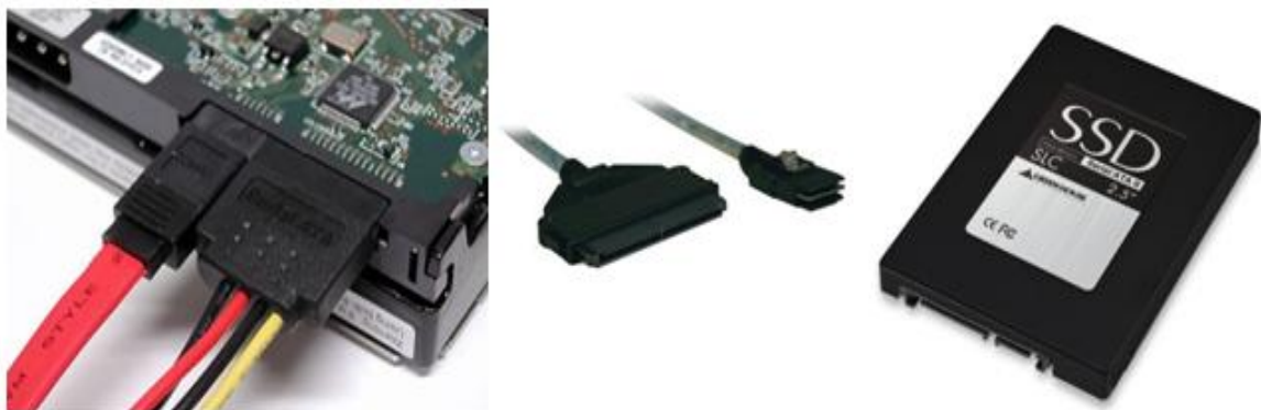
ნახ.1. მონაცემთა დამუშავების ცენტრებში გამოყენებული მეხსიერების მოწყობილობათა ინტერფეისები: SATA და SAS. SSD-დისკი
