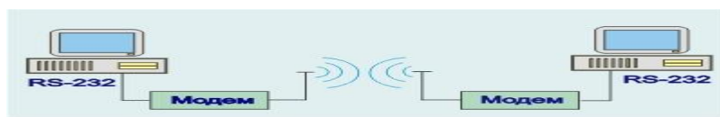
ნახ.2. უსადენო კომპიუტერული ქსელის აგება რადიო-მოდელების მეშვეობით
