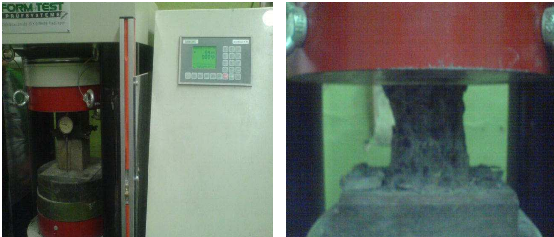
სურ. 6; ბეტონის ნიმუშების კუმშვაზე გამოსაცდელი წნეხი ALFA-300
