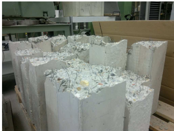
სურ. 4. ლითონის ფიბრა ბეტონში
