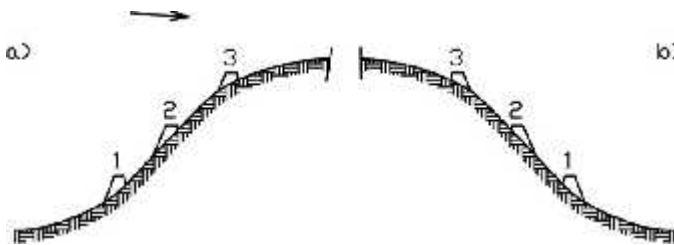
ნახ. 4 რკინიგზის მიწის ვაკისის შესაძლო განლაგებები ქარპირა და ქარზურგა ფერდოებზე და შესაძლო დანამქრის გრაფიკები მათი სიმაღლისა და ქარის სიჩქარის სიდიდეთა მიხედვით
