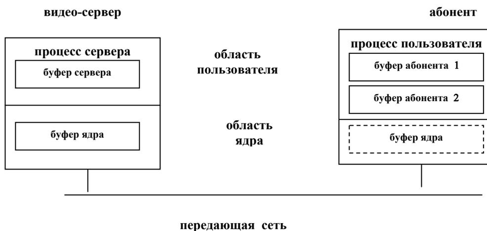
Рис.2.11. Буферизация потоков фреймов
