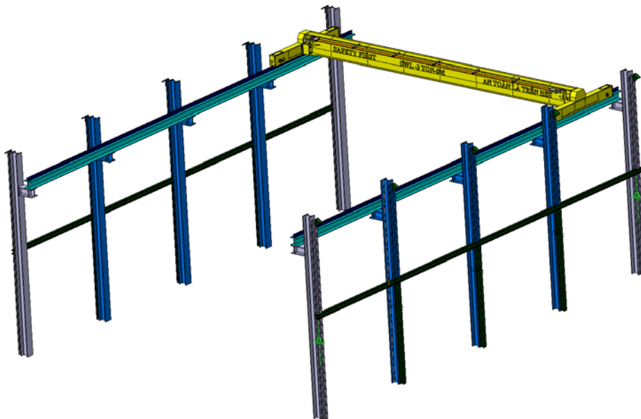
ფიგურა 12. მომსახურების დარბაზში მოთავსებული 3 ტონიანი ტვირთამწეობის მქონე ამწეს კონსტრუქცია
