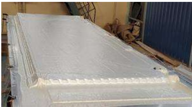
სურ. 56 მოდულის საბოლოო შეწებება. ვაკუუმის მეშვეობით იქმნება 25 ტონის ეკვივალენტის წნეხი მოდულის საერთო ფართის მიმართ, რაც ხელს უწყობს მაქსიმალურად იყოს მოდულის საპროექტო ზომები დაცული
