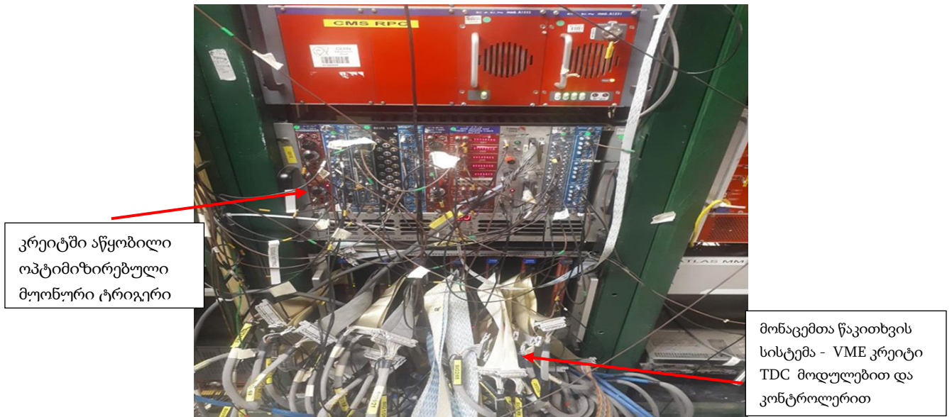
სურ. 12 მუონების ოპტიმიზირებული ტრიგერი GIF++ დანადგარზე მონაცემთა წაკითხვის სისტემასთან ერთად.
