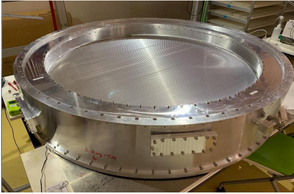
სურ. 35 სრული მოდულის კონსტრუქცია შევსებული სტროუ მილებით
