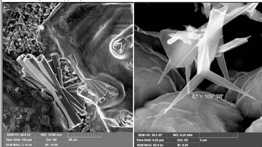
ნახ.1. ZnO-ს მიკრომილაკები, გაზრდილი თხევადი მარილიდან (მარცხენა სურათი) და იგივე მასალის ნანო-ტეტრაპოდი მიღებული პიროლიზით.
