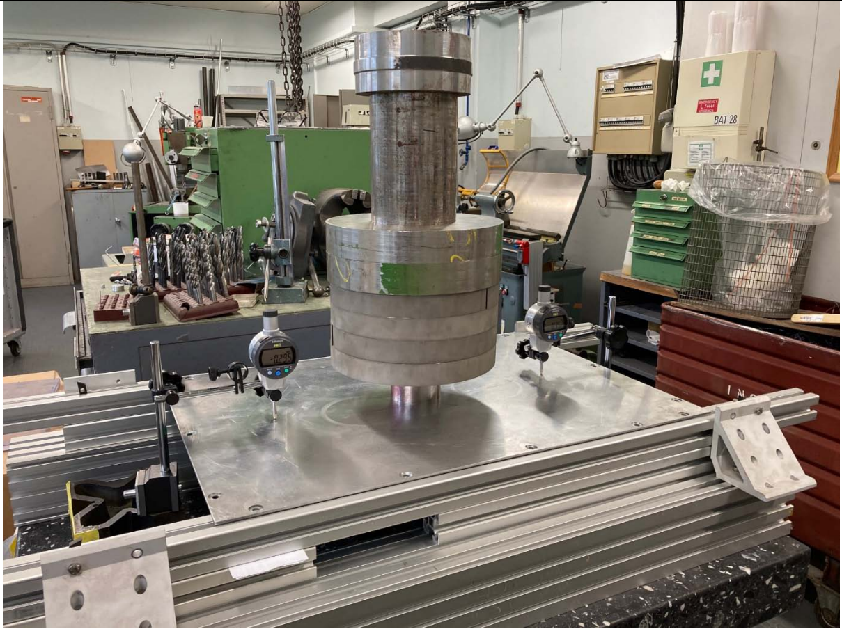
სურ . 14 თერმული იზოლაციის პანელის გამოცდა მექანიკურ დატვირთვაზე
